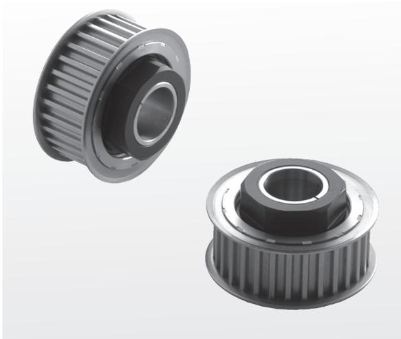
時規皮帶輪內徑及套筒外徑呈現錐形，可透過連接固定螺帽，令時規皮帶輪在錐形面上滑動及移動。此時會因為楔形效應而產生推壓軸及錐形內面的力道  $P \cdot P'$ 。這股  $P \cdot P'$  的力道會產生使時規皮帶輪及軸確實連接的摩擦力。
