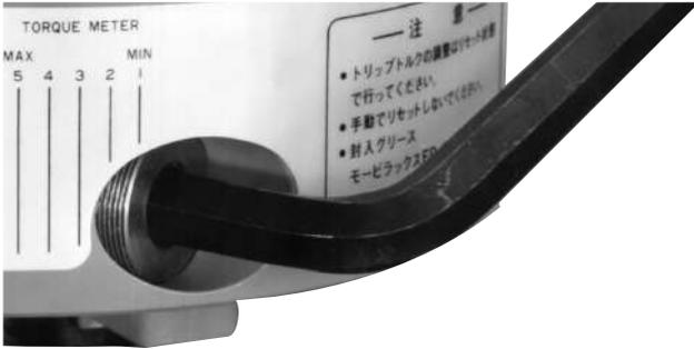
2. 設定扭力前請在調整螺絲部露出面塗抹LOCTITE 243或同等品，以防設定扭力後鬆脫。
